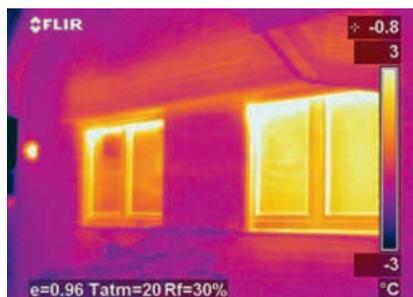
Da dove esattamente fuoriesce l'energia termica? La risposta ce la dà la termografia: le finestre vecchie (gialle) cedono molto calore.
